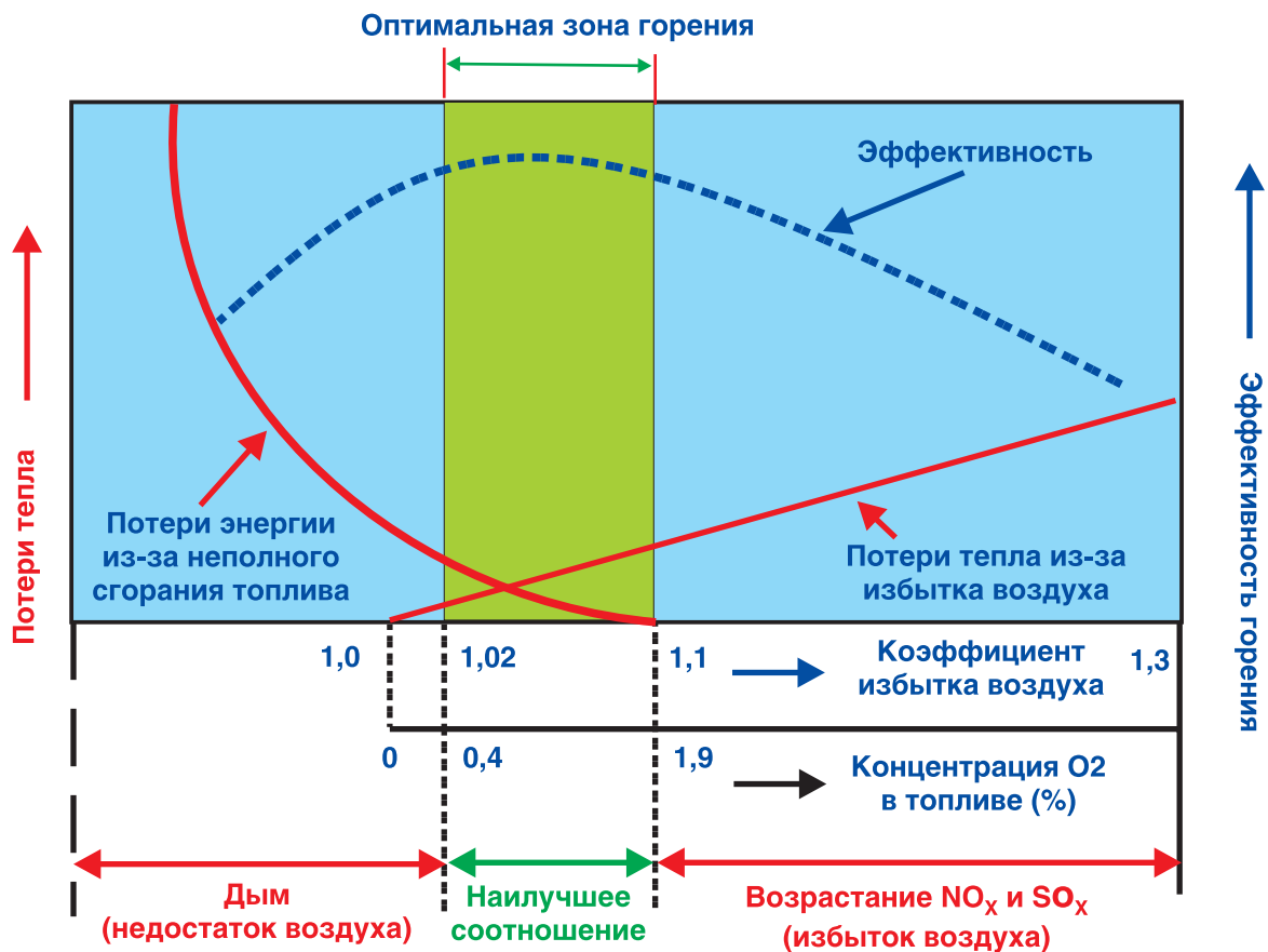
Рис.2. Зависимость эффективности горения от соотношения воздух/топливо
